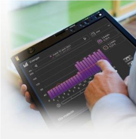
*"Domovea tebis est le logiciel Hager pour la commande et la visualisation d'une installation domotique tebis. Fruit d'une collaboration entre Hager et Microsoft, cette solution domotique permet de contrôler l'ensemble des fonctionnalités électriques d'une maison depuis un PC, une dalle tactile et une tablette PC".*
